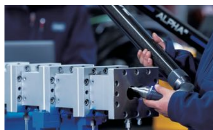
Трёхкоординатная измерительная машина измеряет общую соосность.
