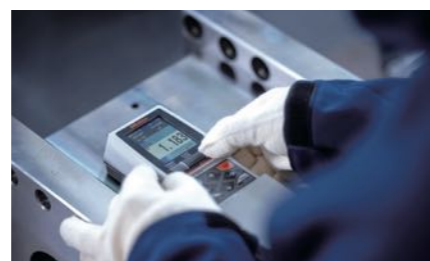
Тестер шероховатости измеряет шероховатость цилиндров экструдеров
