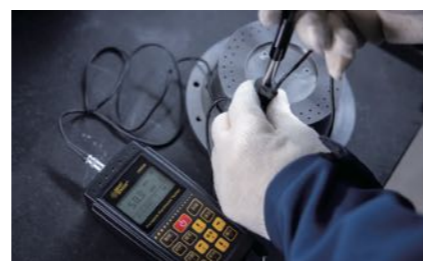
Твердомер Leeb измеряет твердость компонентов экструдера
