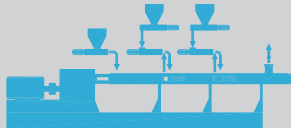
Relleno y refuerzo
